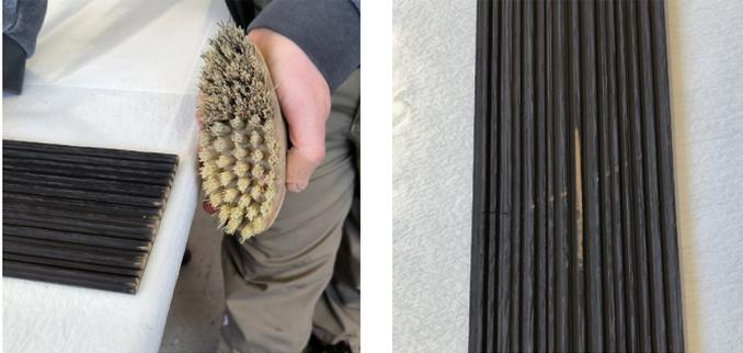
2. Touch-Up Ridgeline dünn mit einem feinen Pinsel auf die Schadstellen auftragen, den Überschuss mit einem Einwegpapiertuch abnehmen.
